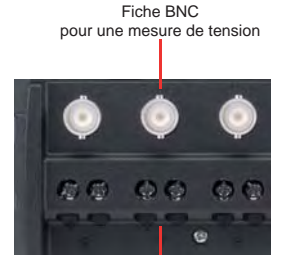
Vis M3 pour une mesure de température ‡ Les deux types de connexion sont disponibles pour chacune des voies
