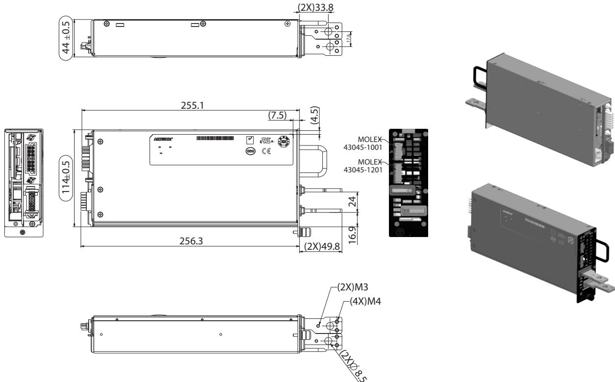
Note : Weight : 3kW module 12V – 32V – 2.2Kg
