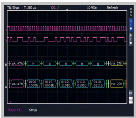
Bus I2C ASCII et binaire
